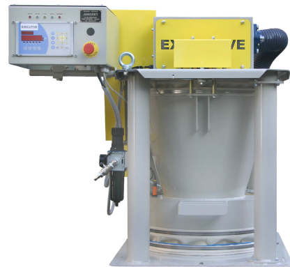
Balance de circuit EXECUTIVE 60+. Benne de pesage 60 litres, portée standard 50 kg, débit : 15 à 20 m 3 /h.
